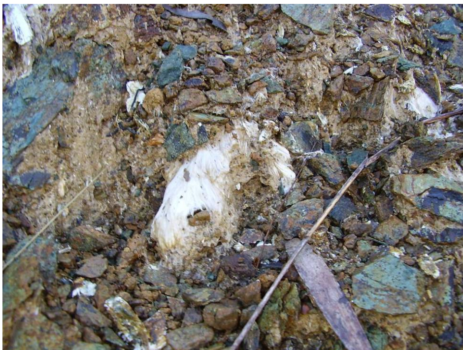
Photo 6 : Tousse cotonneuse, fibres de trémolite, carrière de serpentinite à proximité du collège, commune de Ouégoa
