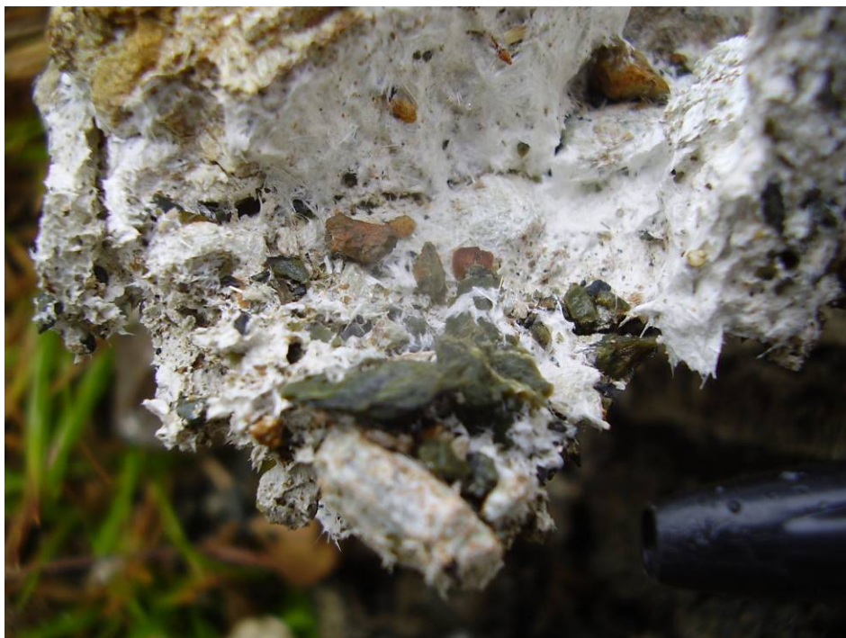
Photo 5 : Amas cotonneux (détail), fibres de trémolite, en bordure de piste entre Bas Coulna et Ouyagette, commune de Hienghène
