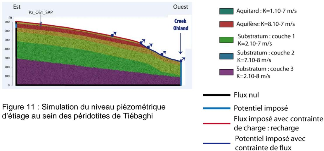
Figure 11 : Simulation du niveau piézométrique d'été au sein des péridotites de Tiébaghi
