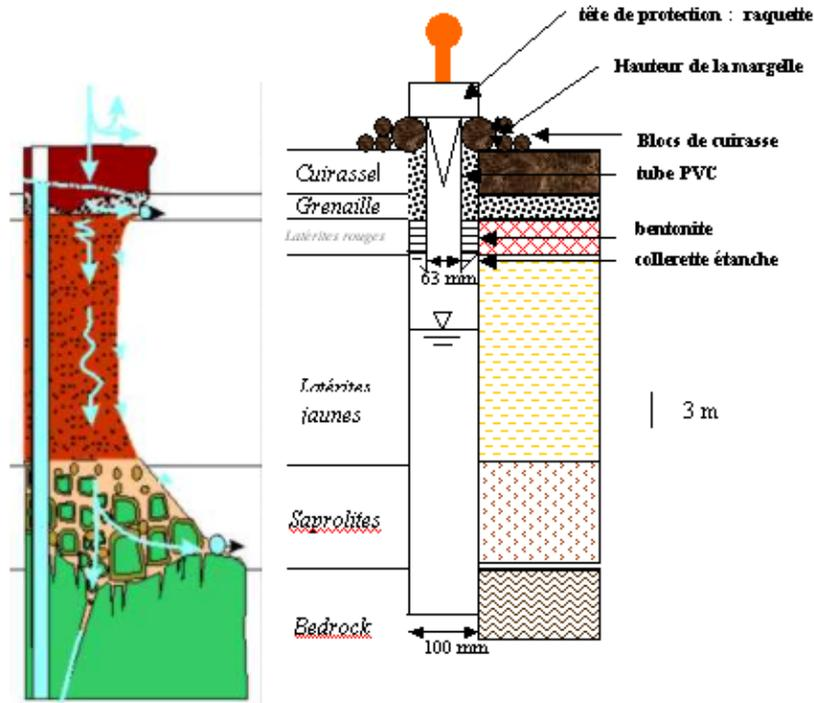
Figure 25 : Schéma d'installation d'un ouvrage temporaire
