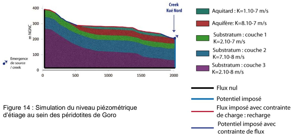
Figure 14 : Simulation du niveau piézométrique d'étiage au sein des péridotites de Goro
