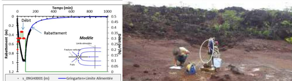
Figure 16: Pompage d'essai sur un piézomètre (Massif de Goro) (cliché source JL. Join)
