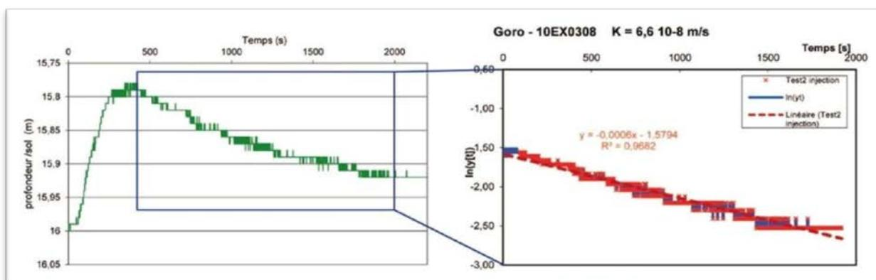
Figure 17 : Réponse « classique et fréquente » au slug test
