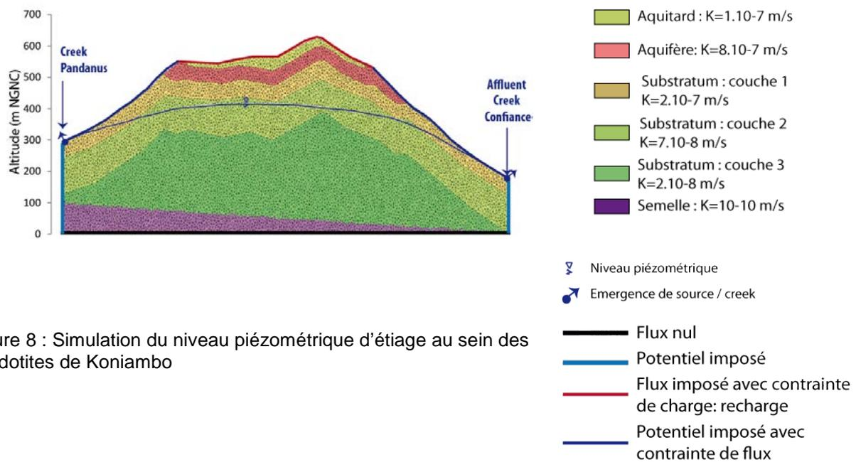
Figure 8 : Simulation du niveau piézométrique d'étiage au sein des péridotites de Koniambo
