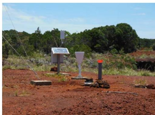
Figure 19 : Station pluviométrique complète sur le site de l'Ancienne Pépinière à Goro, Massif du Sud (source J. Jeanpert)
