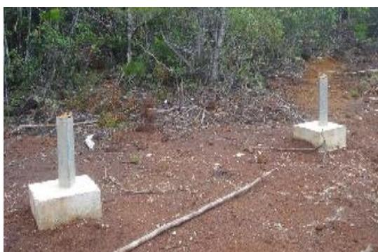
Figure 27 : Plateforme piézométrique (Massif de Goro) (source Golder)
