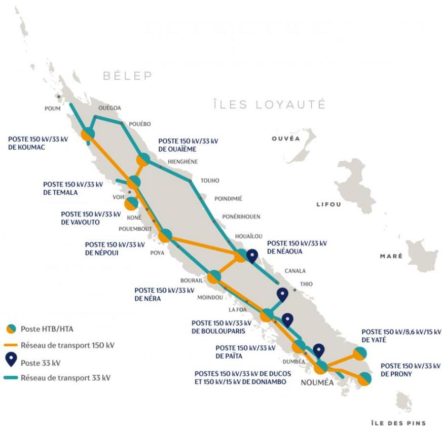
Lignes des réseaux de transport d'électricité en Nouvelle-Calédonie
