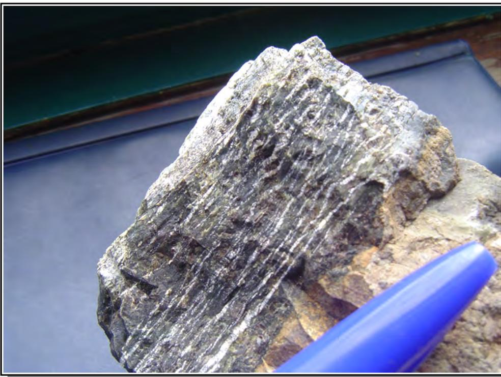
**Figure 3 : Filon de chrysotile silicifié – détermination à confirmer**
