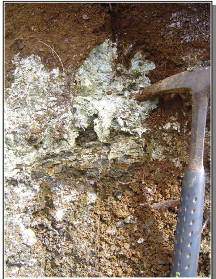
**Figure 5 : Antigorites fibreuses moyennement altérées (photo gauche) et fortement altérées (photo droite)**
