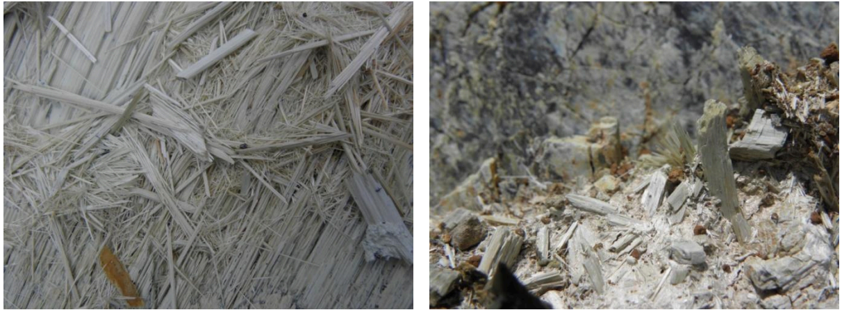
Figure 3 : Exemples d'occurrences fibro-lamellaires d'antigorite
