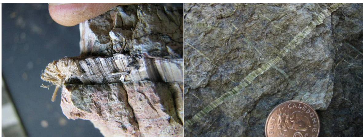
Figure 2 : Exemples de veines et veinules de chrysotile
