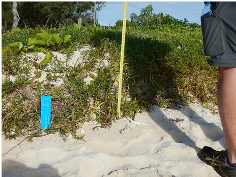
Figure 73 : Formation d'un talus de 40 cm de hauteur situé en haut de plage (07/05/2017)
