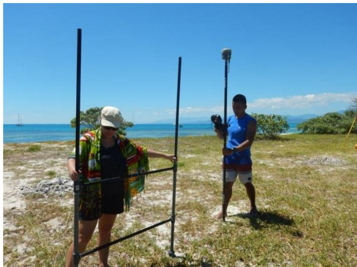
Figure 113 : Levé d'un profil de plage au cadre et au DGPS en simultané (02/11/2016)
