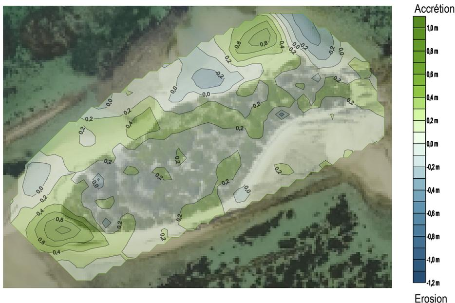
Figure 64 : Exemple de création d'un MNT différentiel (entre mars 2016 et avril 2017, Larégnère)
