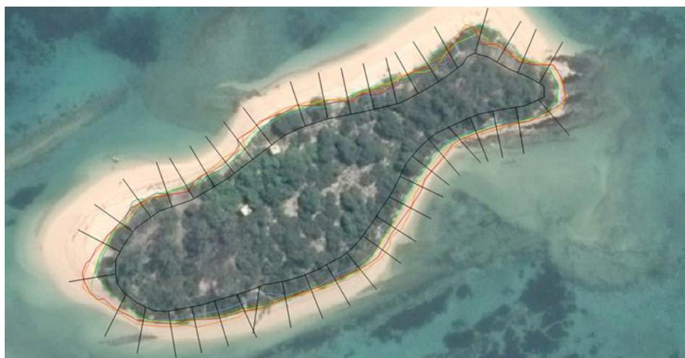
Figure 16 : Transects équidistants de 10 m créés autour d'une ligne de base virtuelle, exemple îlot Larégnère
