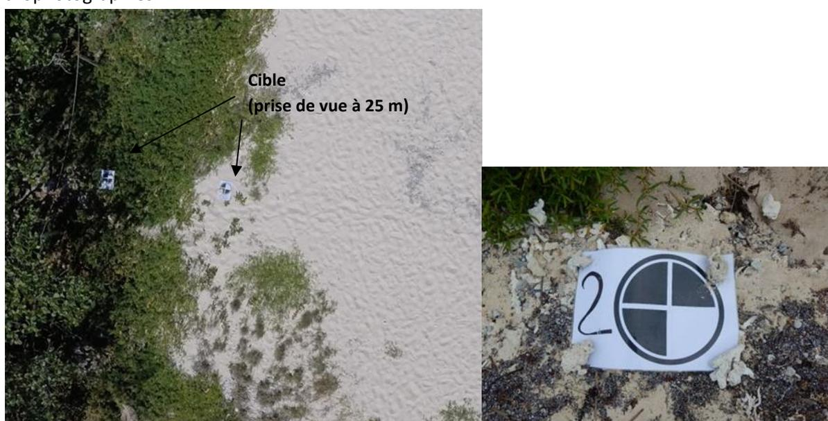
Figure 57 : Exemple de cibles disposées sur l'îlot Larégnère lors de la mission du 02/11/2016 (image drone)
