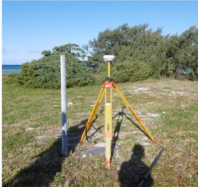
Figure 112 : Repère fixe et base du DGPS installée lors du levé terrain du 05/07/2017 sur l'îlot Mbé Kouen
