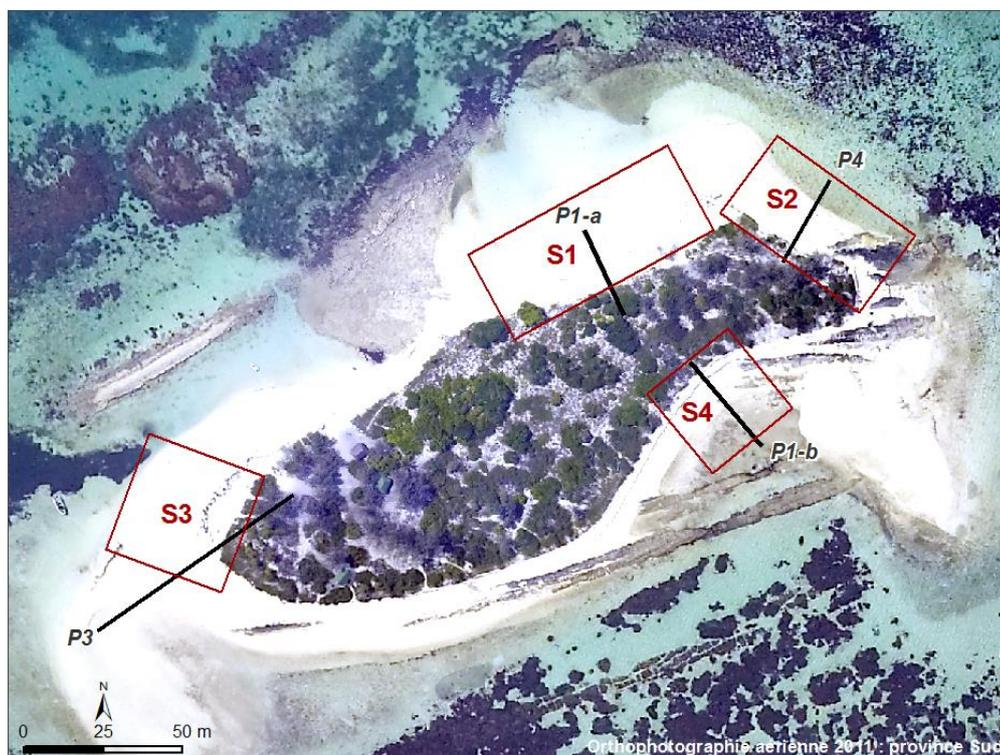
Figure 68 : Localisation des différents secteurs et des profils de plage utilisés pour l'analyse des évolutions actuelles et exposition de l'îlot aux différentes conditions de vagues, îlot Larégnère
