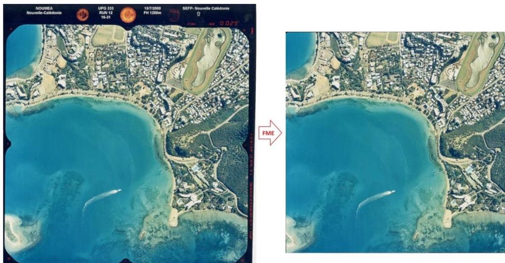
Figure 11 : Rendu d'une photo de la campagne DITTT\_2000\_SEFP\_NOUMEA\_80c avant (à gauche) et après découpage (à droite) à l'aide de FME
